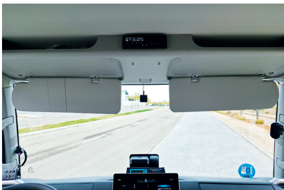
La lejanía del parabrisas, al estilo monovolumen (o camión de larga distancia incluso) permite colocar dos amplias bandejas sobre el parabrisas.
