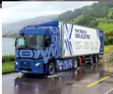
**3 Con su camión** laboratorio Oxygen, ha comenzado pruebas de distribución urbana en Ámsterdam con un prototipo carrozado con una caja frigorífica.
