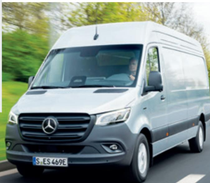
**2 La nueva eSprinter** monta un nuevo motor eléctrico acoplado al eje trasero, lo que la convierte en un vehículo con propulsión trasera frente a la tracción delantera de la variante anterior.
