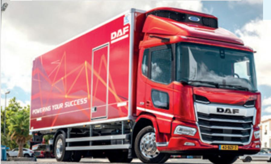
**3 Ha actualizado** sus motores Paccar MX-11 y MX-13: sincronización de válvulas (según ciclo Miller), bomba de refrigerante con doble accionamiento (eléctrico y por correa), compresor de aire de dos cilindros con embrague, turbo y EGR actualizados y preparación para biodiésel B100 Fame.
