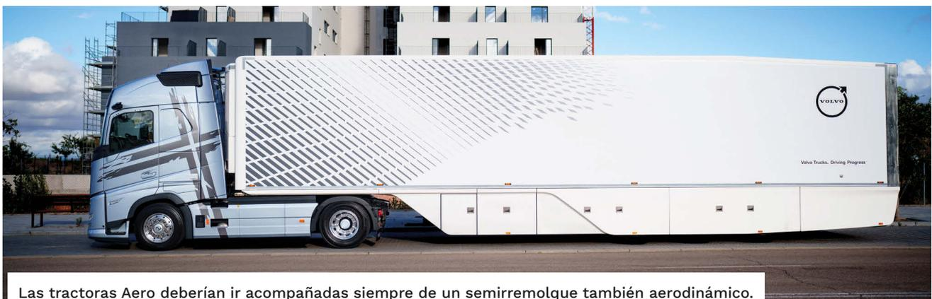
Las tractoras Aero deberían ir acompañadas siempre de un semirremolque también aerodinámico.
