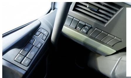
La botonería empleada para el manejo de los retrovisores traccionales se mantiene para las cámaras retrovisoras.
