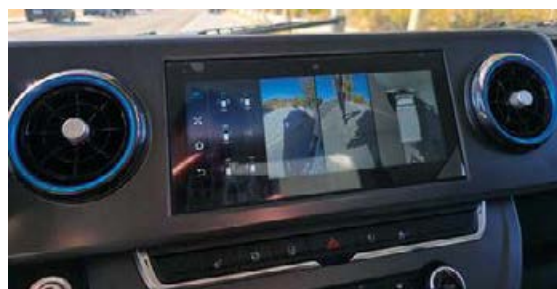
Las cámaras exteriores permiten la visión 360°. Ni un punto ciego en el perímetro del eAumark.
