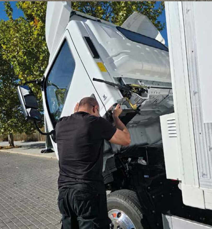
El abatimiento de la cabina es manual y no entraña ninguna dificultad.
