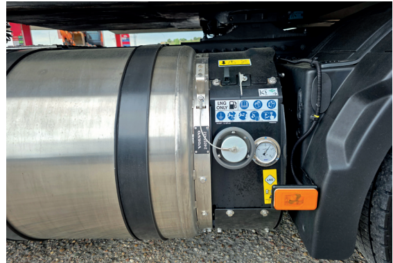
La presión del gas está controlada en todo momento. Si supera los 16 bares, se abre una válvula de seguridad y el conductor es informado de ello en el cuadro de instrumentos.
